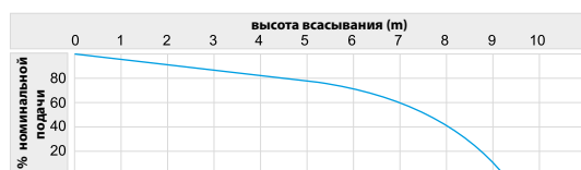
Падение подачи для разной высоты всасывания
