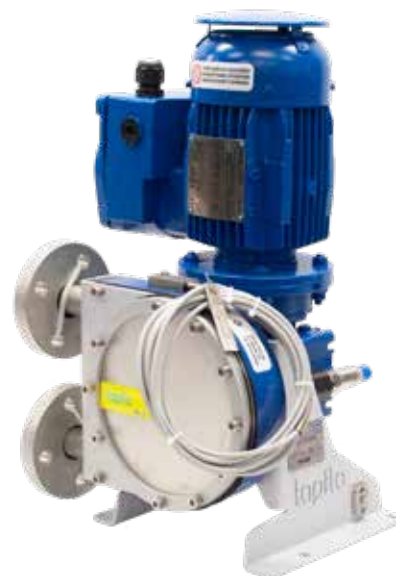
Взрывозащищённый PTXL13 с фланцем DN20, защитной крышкой электродвигателя, датчиком температуры и детектором утечки шланга
